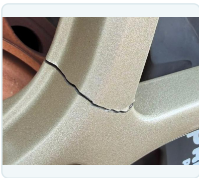
实物裂纹·根部过渡区
